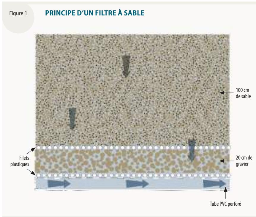
une réorganisation du substrat, les matériaux les plus gros se rassemblant vers la surface et les plus fins vers le fond du filtre.
