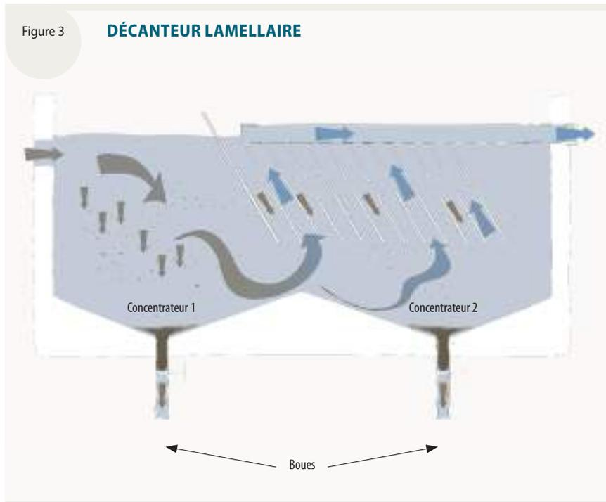
L'inclinaison des plaques permet d'augmenter la surface efficace pour la décantation d'une particule. Un angle de  $60^\circ$  permet d'optimiser le flux et le glissement des boues vers le fond du bassin.
